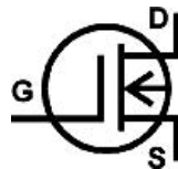
Isolierschicht-FET (selbstleitend, N-Kanal)
